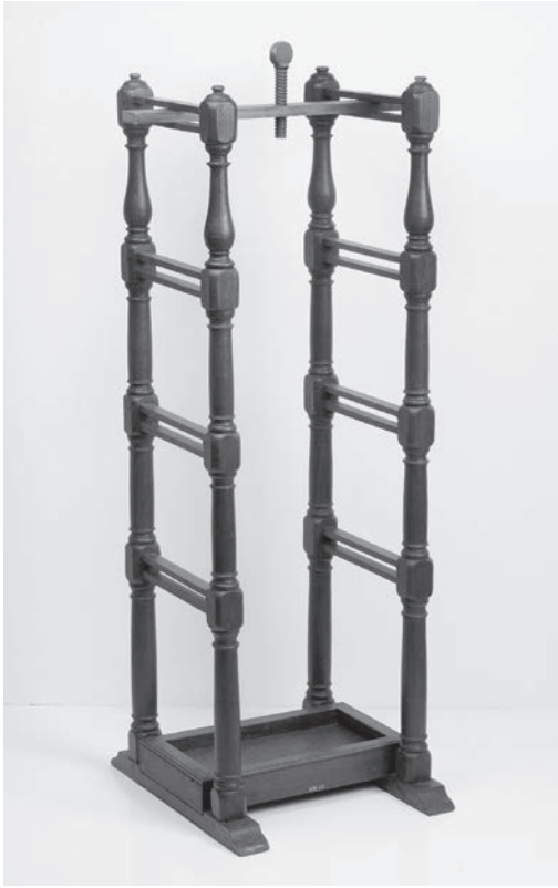
Fig. 2: 's Gravesande's fall apparatus. (Museum Boerhaave, V09630)
